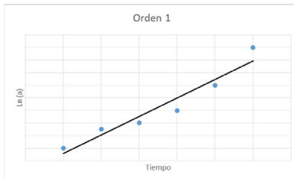
Figura 10. Gráfica del Logaritmo natural de la actividad ( \ln(a) ), del catalizador como una función del tiempo.
